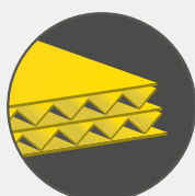
5 warstwowa tekstura falista: udźwign ok. 30 kg
