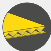
3 warstwowa tekstura falista: udźwign ok. 15 kg
